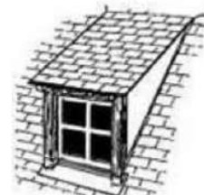
lucarne rampante ou en chien couché
