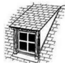
lucarne rampante ou en chien couché
