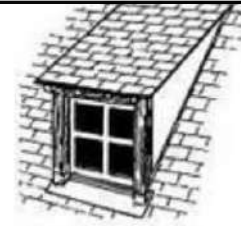
lucarne rampante ou en chien couché
